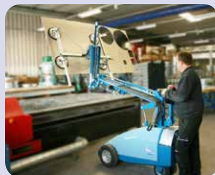
CLAD-LIFT без кабельная транспортировка листов
