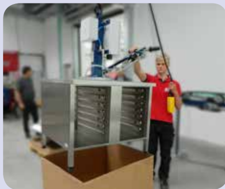
Выгрузка со стеллажей устройством на батарее
