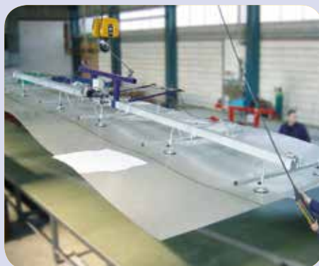
Переноска тонких листов специальной формы
