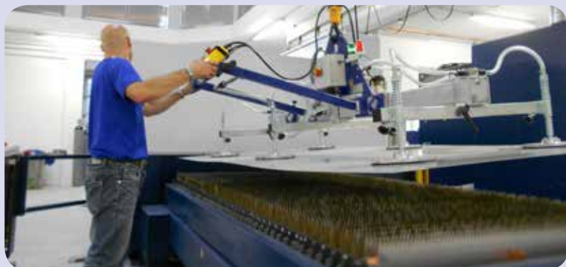
Вакуумное устройство AERO 900/6R для погрузки на машину лазерной резки
